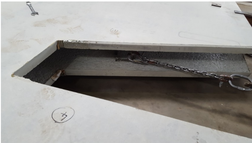
Baumusterprüfung unter Schrägzug 70°, eine typische Beanspruchung für hohe Wände unter Luftdrehung
