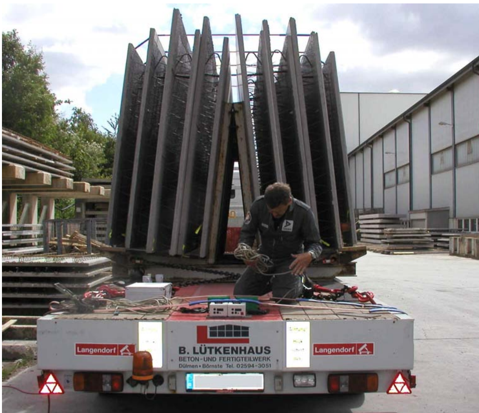
Mit Fahrversuchen wurde geprüft, ob die annähernd in die Umreifung gezurrte Ladung ohne Formschluss nach vorne ausreichend gesichert ist. Foto: Syspro
