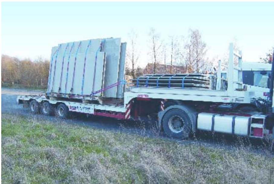
Bildbeispiel aus der Ladeempfehlung für Wand- und Deckenelemente aus Beton: Element im A-Bock ohne Formschluss nach vorne; der A-Bock ist durch Ketten vorne und hinten im Diagonalzurrverfahren oder über Twist Look Verbindungen zu sichern. Foto: Syspro/Lütkenhaus
