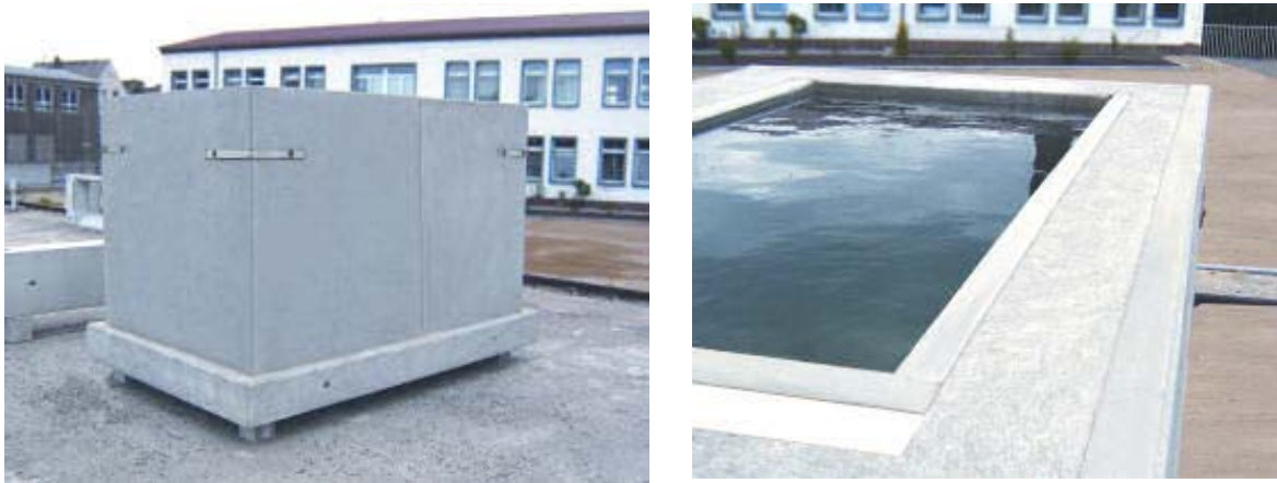
Bild 5: Versuchstank im Betonwerk Oschatz; rechts die Draufsicht auf die Wasseroberfläche. Foto: Betonwerk Oschatz
