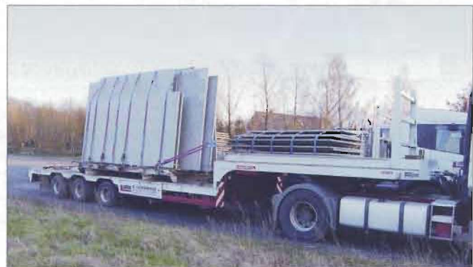
Bildbeispiel aus der Ladeempfehlung für Wand- und Deckenelemente aus Beton: Element im A-Bock ohne Formschluss nach vorne; der A-Bock ist durch Ketten vorne und hinten im Diagonalzurrverfahren oder über Twist Lock Verbindungen zu sichern.
