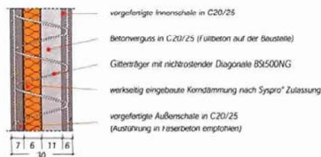
Aufbau einer Thermowand
